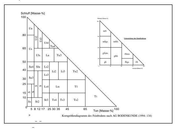
Abbildung 2: Verwendete Korngrößendiagramme und Bodenartbezeichnungen
