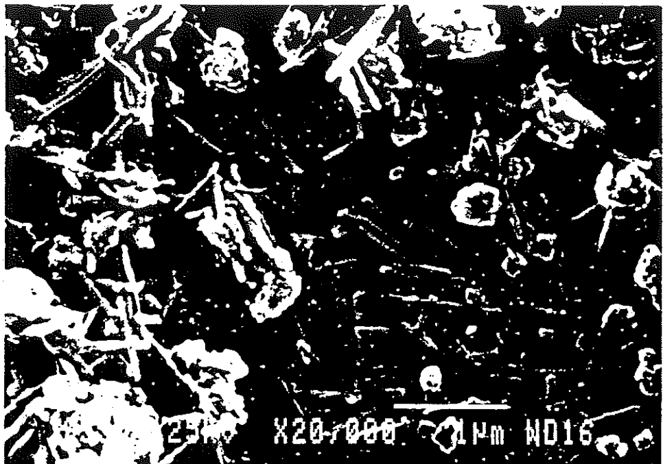
Foto 24: c) Probe Eto 93-E, Tonfraktion < 2 \mu\text{m} (Ostteil der Etoscha Pfanne; vgl. auch Abb. 72): nadelförmiger Sepiolith/Loughlinit und "Klumpchen" von Analcim.
